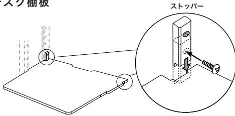
デスク代わりに使える便利な棚板です。棚板の一種なので5cm刻みで高さを変えられます。棚板の奥が浮かないよう、専用のストッパーが付属します。
