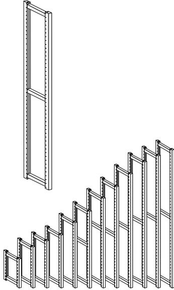
イキクッカの基本骨格をつくるための縦枠（たてわく）です。側面は開いていて、必要に応じてサイドパネルでふさぐことができます。標準品の高さは12種類ですが、5cm刻みでご希望の高さのアップライトも製作いたします。
