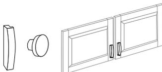
ドアの適当な位置に直径4.5ミリのドリルで穴を開けて取り付けます。M4の取り付け用ネジが付属します。ドアのご購入時、取付け穴加工サービス(無料)がご利用頂けます。
