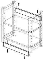
最下段棚板の手前裏に取り付ける幕板です。用途はこの他に、棚板奥に上向きに取り付けて収納物の落下防止板として使ったり、フックを取り付けて吊り下げものの収納に利用したり、工夫次第で色々な使い方ができます。
