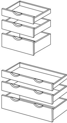
専用の金属レールをアップライトに取り付けて使用する引出しです。好きな場所に1個単位で取り付けられ、スムーズな開閉が特徴です。アップライトのピン穴2つ分、3つ分、4つ分がそれぞれ引出しの高さ10cm、15cm、20cmに相当します。
