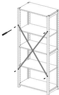
棚ユニットを安定化させるために必要な筋交です。付属の4本の木ネジでアップライトにネジ留めします。横方向に何連もつながった棚の場合は、1つおきにクロスブレースを取り付けます
