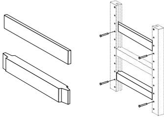
アップライトの側面から本などが落下するのを防ぐ板です。薄手タイプは市販のS字フックなどと組み合わせて使用すると、アップライトの側面にもものを吊り下げることができます。厚手タイプはアップライトと同じ厚み（36mm）のため取り付け時に段差ができません。
