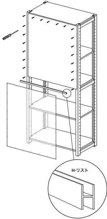
棚ユニットの背面を塞ぎたい場合に使用します。クロスブレースと同様にユニットを横方向に安定させるためのパーツでもあります。背板のみでユニットを安定化させる場合、ユニットの高さの半分以上の長さの背板が必要になります。
